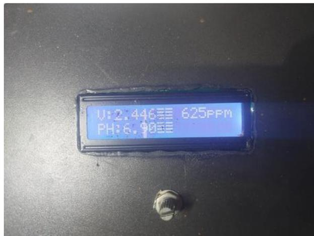
**Gambar 3.4 Hasil Pembuatan Kontrol pH dan PPM**
