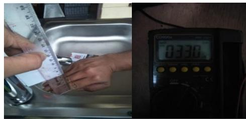
Gambar 11. Proses pengukuran tegangan pada jarak 6,5 cm
