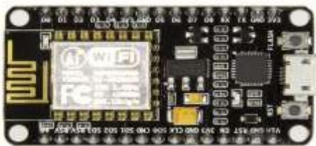
Gambar 2. NodeMCU ESP8266
