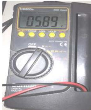
Gambar 21 Hasil pengukuran tegangan penggerak motor
