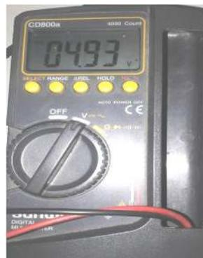
Gambar 22 Hasil pengukuran tegangan output ic regulator Arduino
