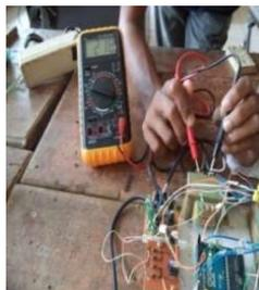
Gambar 11. Pengukuran Tegangan Input Pada Trafo 220 VAC
