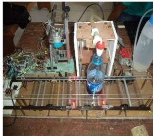
Gambar 18. Rangkaian Percobaan Sistem Pengisi Cairan Dan Penutup Botol Otomatis
