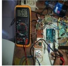
Gambar 12. Pengukuran Tegangan Pada Output 12VDC
